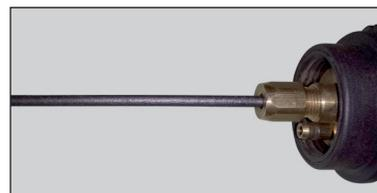
• Cortar el revestimiento de teflón de carbono que sobresale respecto de la antorcha, de manera que la parte que queda después de la tuerca de fijación sea
