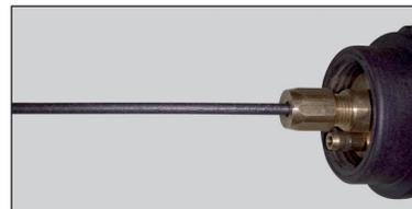
• Couper la gaine en téflon carbone dépassant de la torche, de sorte que la partie restant après l'écrou de verrouillage soit exactement de 3.75" (3 3/4").
