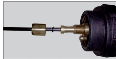
• En el revestimiento que sobresale de la antorcha insertar el mandril de latón, la junta tórica y la tuerca de fijación. La tuerca debe ser apretada a mano. Si queda demasiado apretada puede dificultar la alimentación del hilo de soldadura.
