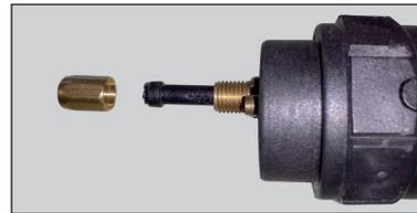
• Quitar el revestimiento metálico presente en el interior de la antorcha de soldadura, véase la figura.
